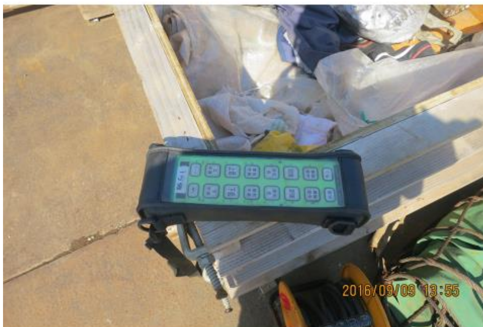
写真一 2 7 定置式クレーンが設置された日本の工事現場（著者撮影） （平型の無線操作盤；手持ち式）
