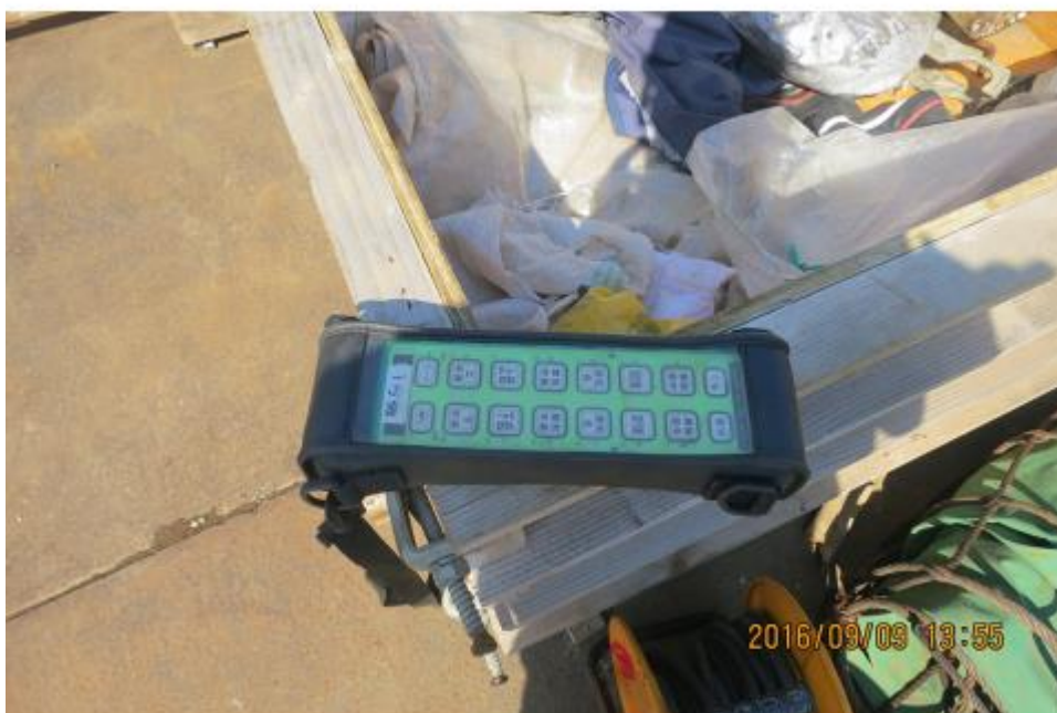
写真一 2 1 日本 の 定 置 式 クレーン が 設 置 さ れ た 工 事 現 場 （ 著 者 撮 影 ） （ 平 型 の 無 線 操 作 盤 ； 不 使 用 時 の 仮 置 き ）
