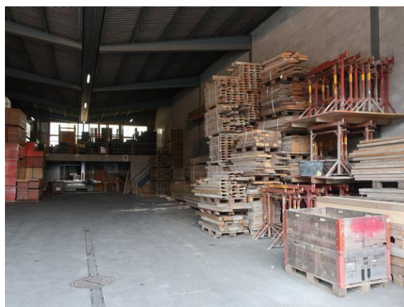
型枠資材倉庫 (奥に切断加工機械が見える)
